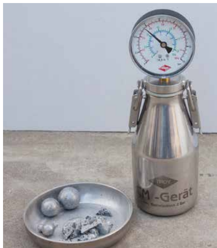
Bestimmung der Restfeuchte mit der CM-Messung
